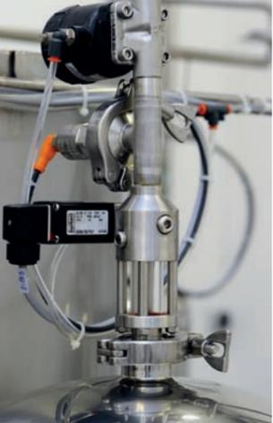
Mesure automatique du niveau de colmatage des filtres et régénération automatique des filtres.
